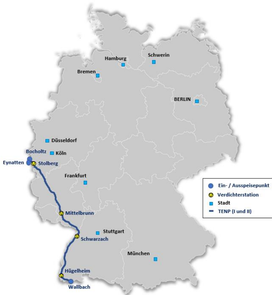
Abbildung 3: Der Verlauf der TENP-Leitung, Ein- und Auspeisepunkte, sowie die Verdichterstationen entlang der Leitung.
