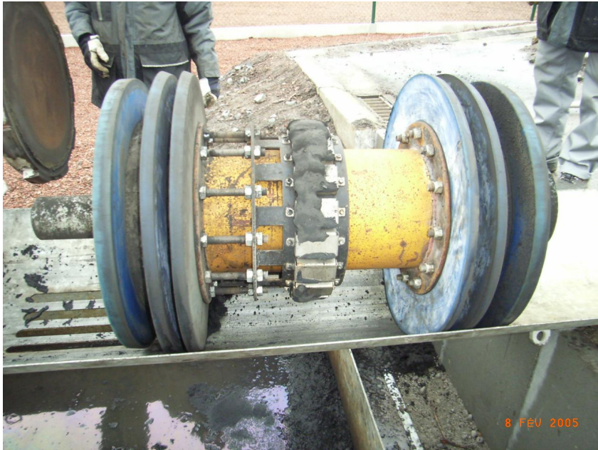
Cleaning pig avec aimants
